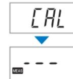
MEAS(測定)ボタンとCAL(校正)ボタンを押し間違えています。校正からやりなおし、再測定してください。
