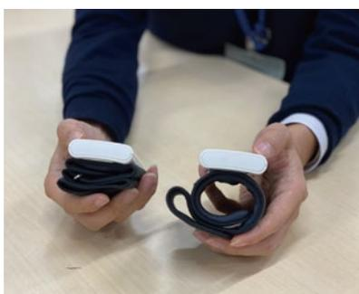
写真2 開発初期段階で採用していたカフ(左)と手首にフィットするように改良されたカフ(右)の2種類を試作。
