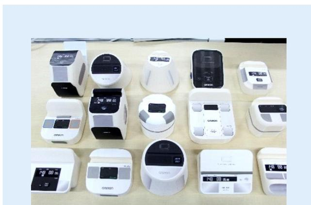
試作品の数々。測定精度を維持するため、ユーザが無理のない姿勢で安定して機器を操作できるように、本体の形状、電極の形状・位置などを追求した。
