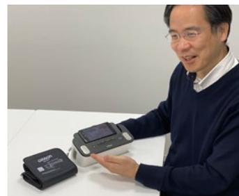
測定精度を維持するため、無理のない姿勢で安定して操作できるようにすることは不可欠でした。そこで、本体はどんな形がいいのか、電極はどこにあればいいのか、指がずれないようにする為には電極の表面はツルツルの素材より突起があるものの方がいいのか——本体の大きさ・形状、電極の位置・角度・形状などを細かく検討していきました。検討にあたって制作した試作品の数は30以上にのぼります」(吉田)
