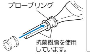
体温計を安定させるために、プローブリングの使用をおすすめします。
