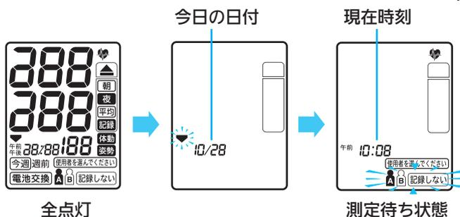
※全点灯時に表示される「電池交換」マークは、電池の交換が必要であることを表していません。点灯確認のため、表示しています。
