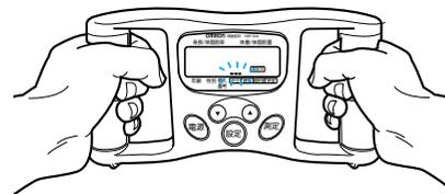
「測定姿勢」表示が消え、「測定中」表示が点灯します。
