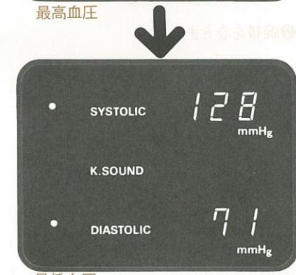
⑦測定が完了しますと、腕帶内の空気は自動的に急速に排気されますので、腕帶をはずしてください。測定時の表示はスタート／クリア・スイッチをどちら側かに押すまで保持されます。
