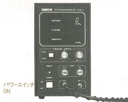
③加圧値、排気速度、最高血圧感度、最低血圧感度を、それぞれのダイヤルを調整して設定します。
