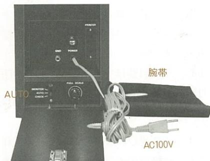
②パワースイッチを“ON”にします。約1分の後、レディ・ランプが点灯したら測定可能となります。この時、最高血圧表示(SYSTOLIC)は0となります。
