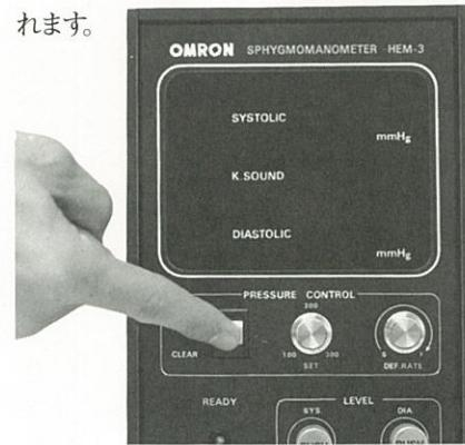
加圧不足の時は、再び“START”側へ押すと、押している間だけ昇圧します。排気が始まつすぐにK.SOUNDコロトコフ音モニタ・ランプが点滅する時は加圧不足です。
