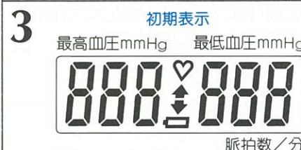
電源スイッチを押すと、表示部がすべて点灯します。これは表示器の点検をしているため約1秒間点灯します。
