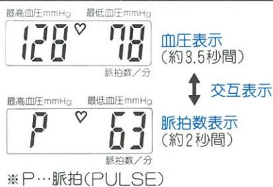
腕帯内の空気が完全になくなると、ブザーが「ピッピッピッピッピツ」と鳴り、「♥」マークが表示されます。
