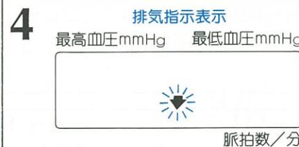
全表示が消えたあと、排気指示マーク「▼」が点滅しますので「▼」が消えるまで排気バルブを押して空気を抜いてください。
