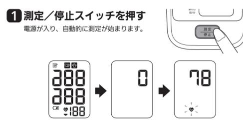
全点灯時に表示される「電池交換」マークは、電池の交換が必要であることを表示していません。点灯確認のため、表示しています。
