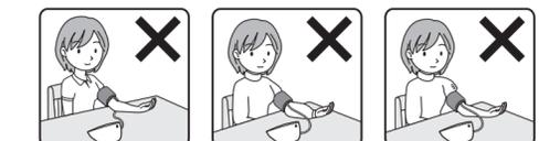
ひじや腕で腕帯チューブを押さえると、腕帯の圧迫力が腕帯に伝わらず、高く測定されます。
