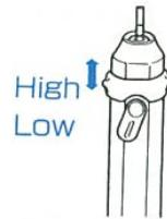
**5** 強弱切替スイッチを、上下に動かし回転数の強弱(High/Low)を調節します。
