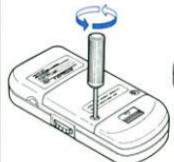
電池カバーをはずし、導子コードカセットを取り出してください。
