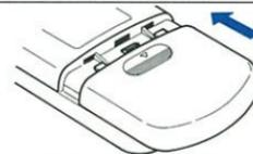
※電池が消耗して、新しいものに交換される場合はS-006P型の乾電池をお求めください。
